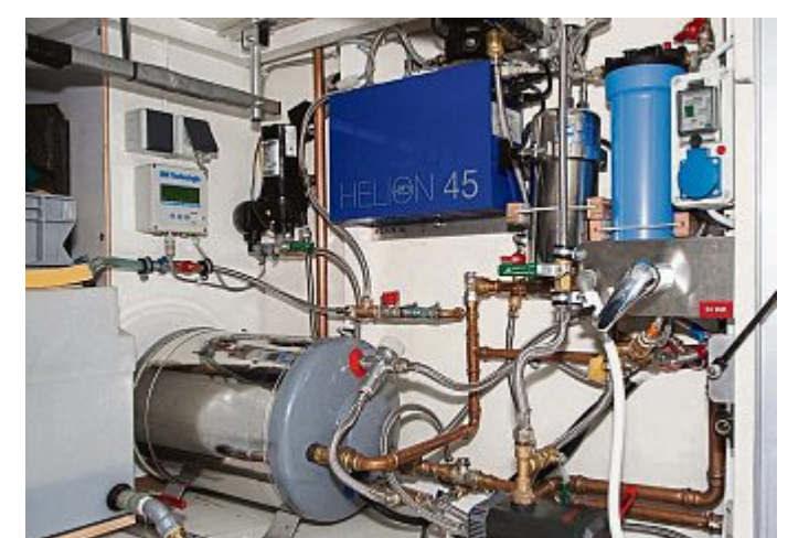
Das Wasseraufbereitungssystem „Helion 45“ im Reisemobil von Tommy Lehn und Constanze Kühnel sorgt überall auf der Welt für frisches Trinkwasser – egal, woher es kommt.
